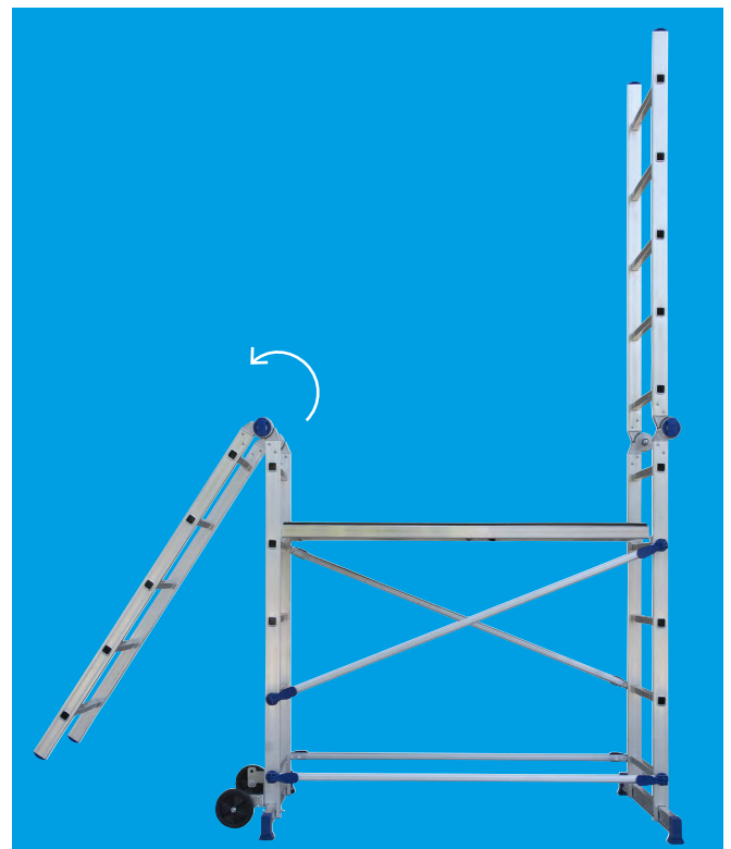
Sistema exclusivo de articulación hacia el exterior que permite no desmontar la parte baja del andamio Sistema exclusivo de articulação para o exterior que permite que a parte inferior do andaime não seja desmontada
